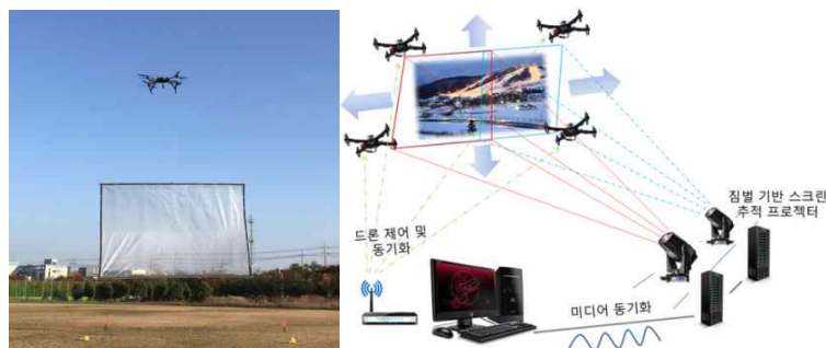
[그림 3-4] 드론을 이용한 홀로그램 스크린 부양 장면과 다중 드론을 이용한 스크린 부양 개요도
