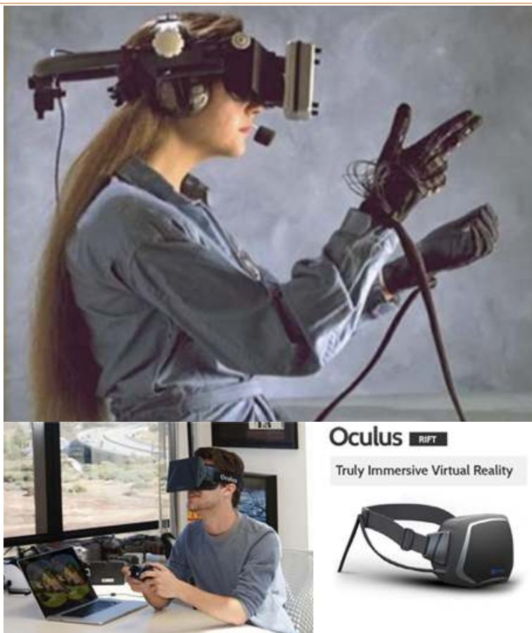
[그림 2-25] HMD(Head-mounted display) 등의 이펙터(effector)를 사용, 사용자의 반응을 감지하기 위해서 데이터 글로브(data glove), 두부위치센서 등의 센서(sensor)를 사용
