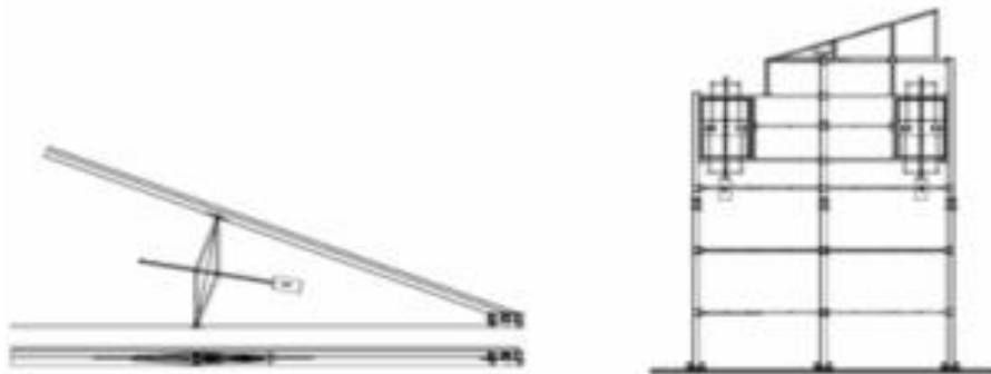
그림 67 경사형 리프트 시스템 구조도, 한국생산기술연구원 제공
