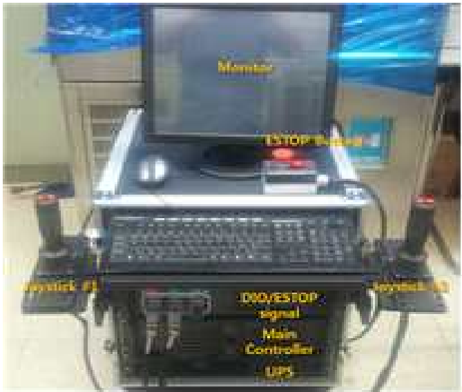
그림 47 3D 와이어 플라잉 시스템 조작을 위한 콘솔장치 세팅 예시, 쇼텍라인 제공
