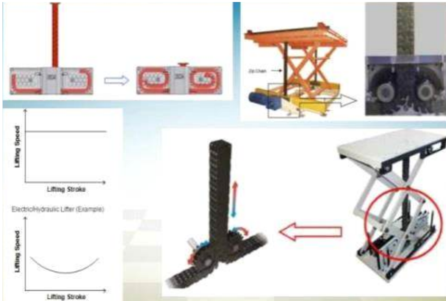
그림 65 수직형 리프트 집체인 방식의 예시, 한국생산기술연구원 제공
