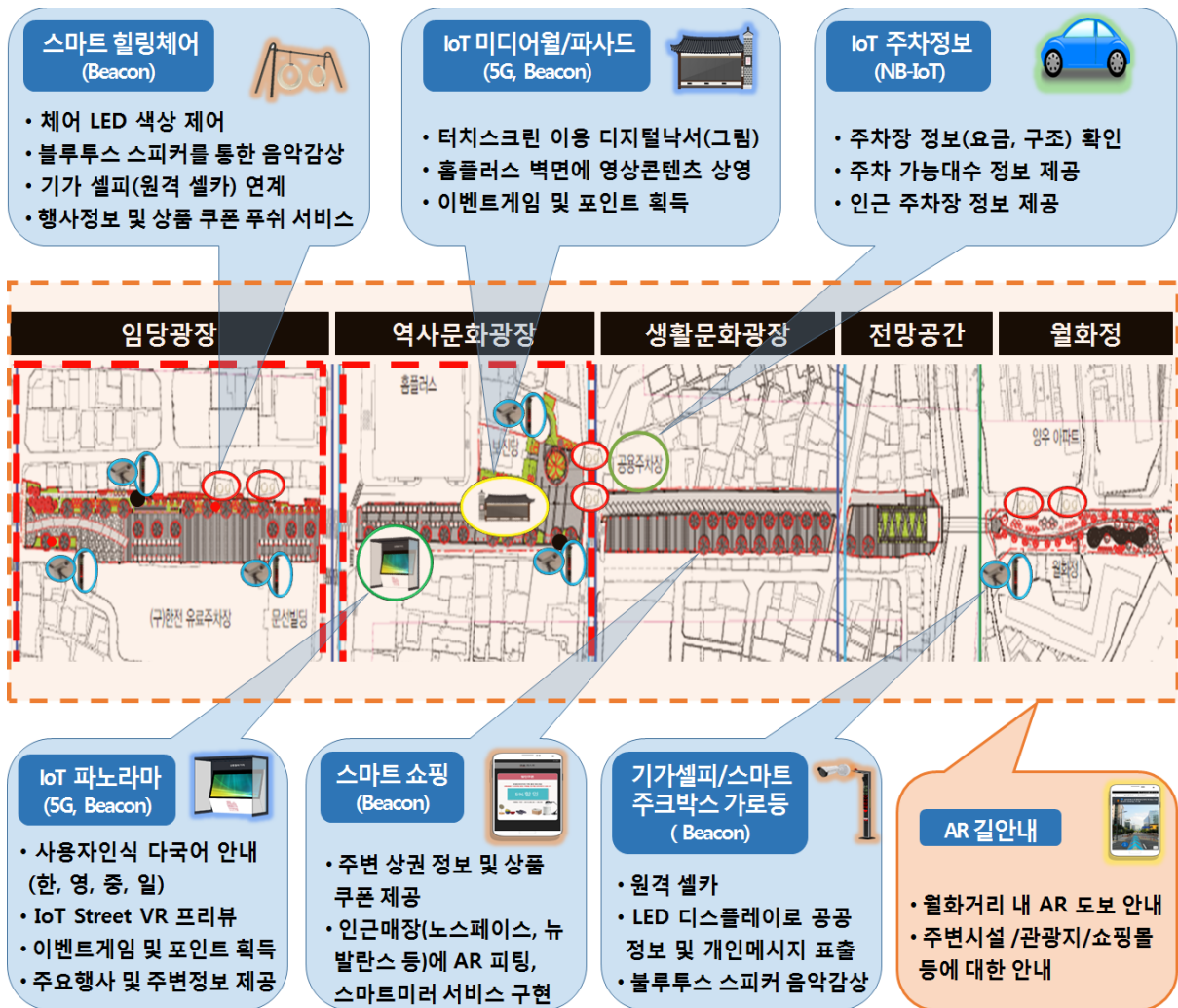
[그림 4-10] 월화거리 IoT Smart - 서비스 구성
