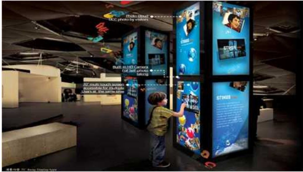
| 그림 76. 디스트릭트 Stikus Cube : STIKUS cube는 기동형태로 사면에서 조망 가능. 양쪽에 설치된 HD 카메라에서 사진을 찍고 multi touch screen 상단의 디스플레이로 사진을 던지면, 360도 Photo cloud에 전시되어 많은 사람들이 즐길 수 있는 효율적인 미디어 플랫폼.
