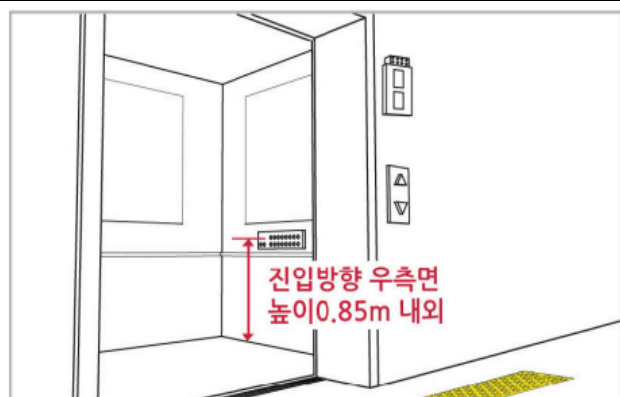
진입방향 우측 0.85m 내외의 높이에 가로형 조작반을 설치한 사례 사진
