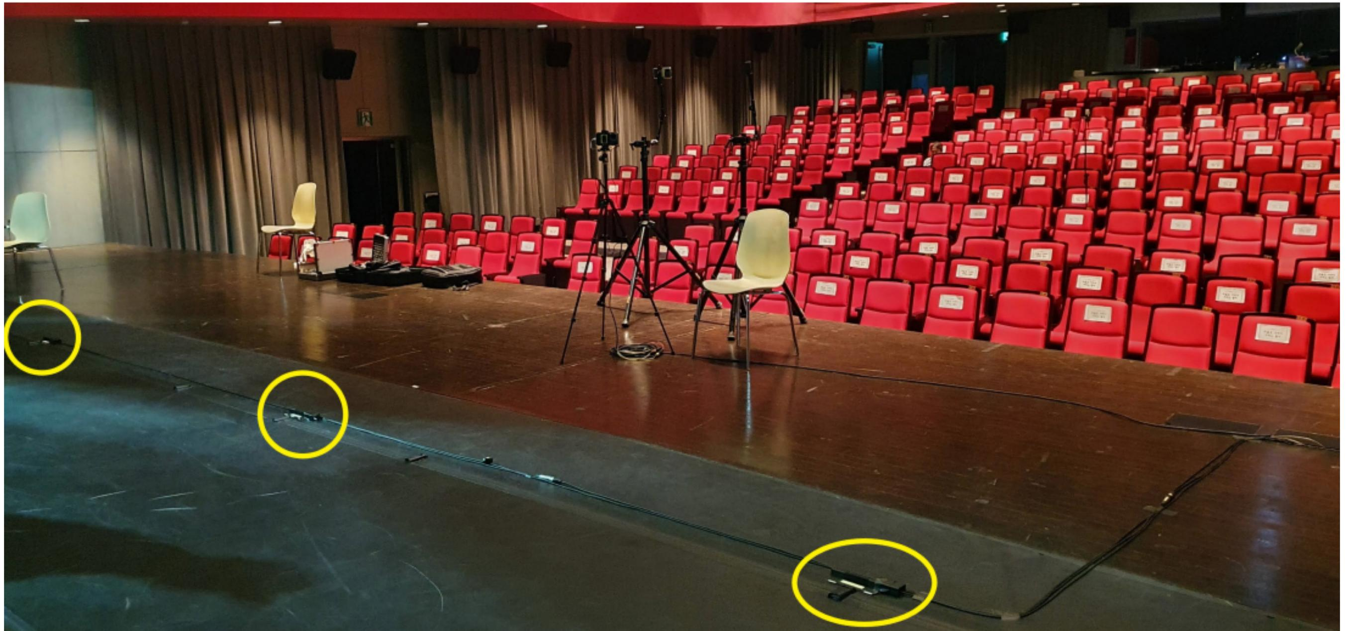
[사진 4] 무대 바닥 Boundary mic Crown PCC160 (무대 센터를 기준으로 3개를 설치하였다.)
